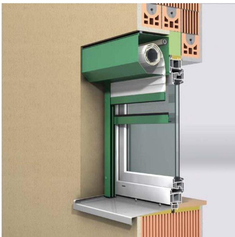
Slika 10-3: Primer zunanjega senčila in energetsko učinkovitega okna (vir: Tehrol)
