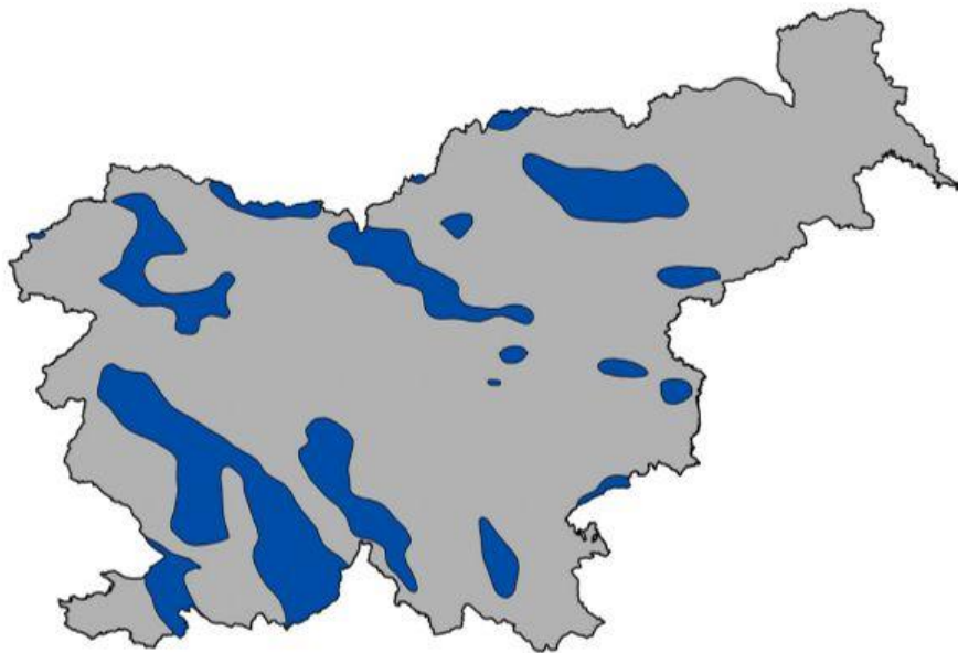
Slika 38: Vetrovno primerna območja – območja s povprečno hitrostjo vetra več kot 4,5 m/s 50 m nad tlemi v obdobju 1994-2000 iz modela Aladin DADA. Vir: Celovit pregled potencialno ustreznih območjih za izkoriščanje vetrne energije – strokovna podlaga za NEP 2010-2030, Aquarius d. o. o., februar 2011.
